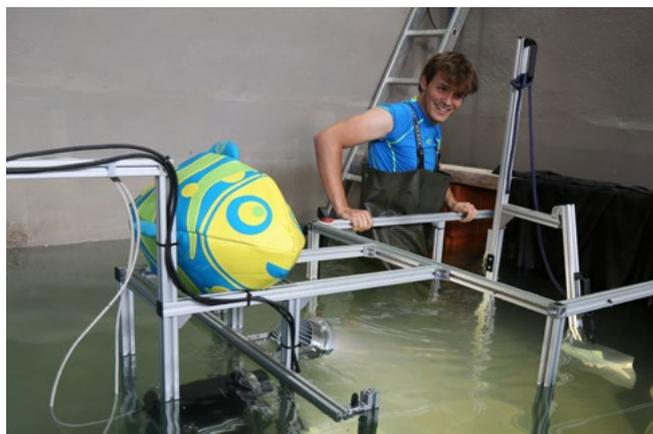
Das Zählen und Identifizieren von Fischen an Wasserkraftanlagen und Staustufen ist aufwändig, aber für den Artenschutz nötig. Unser neues, automatisiertes Fischmonitoringsystem kann Abhilfe schaffen und wird im Hydrolabor Schleusingen, IWSÖ GmbH, erstmals getestet.
