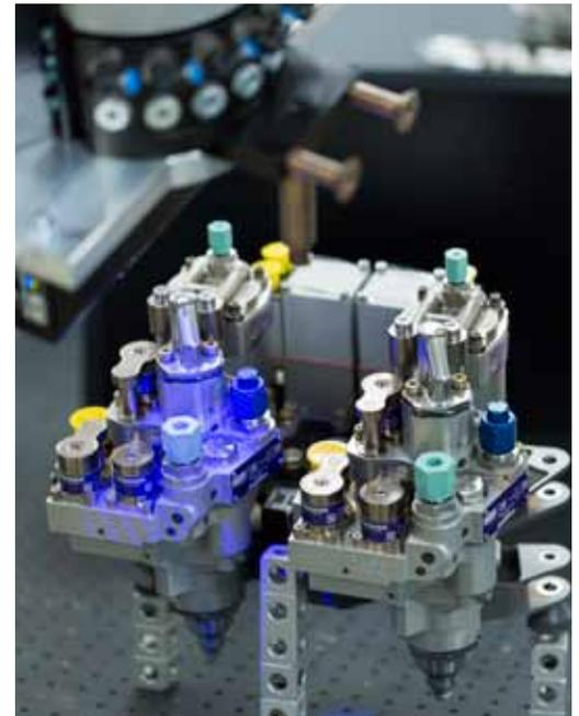
Optisches Vermessen einer Baugruppe, um die Korrektheit der Montage zu prüfen. Die realen Teile werden von der Software mit den digitalen Planungsdaten verglichen. Abweichungen werden sofort erkannt.
